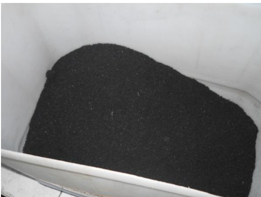
Material reciclado: Partículas de caucho. Fuente: Archivo fotográfico de CEVE
