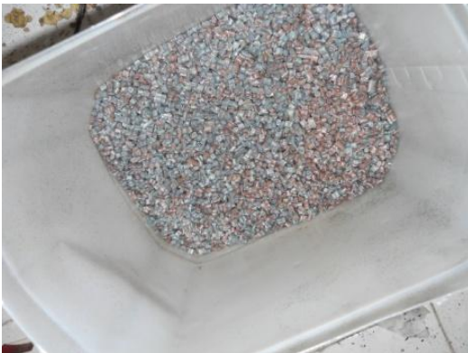
Material reciclado: Partículas de polietileno de baja densidad (PEDB). Fuente: Archivo fotográfico de CEVE
