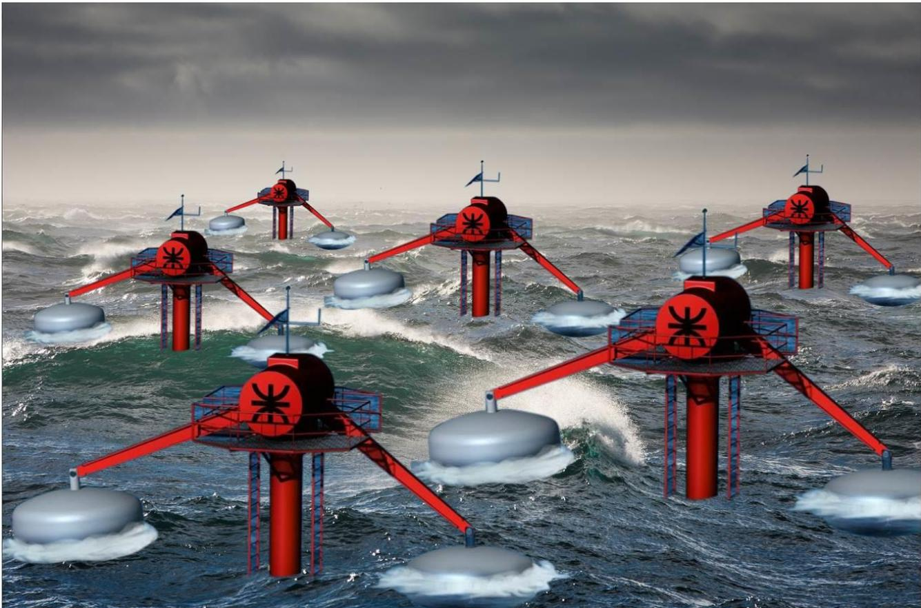
***Máquina electromecánica transformadora de energía undimotriz a energía eléctrica.***
